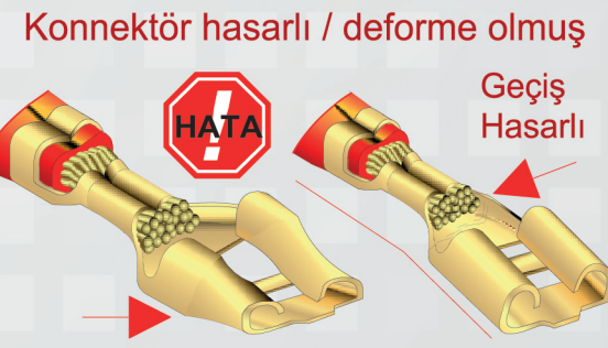
Görünür olmalı, maks. terminal kalınlığı kadar veya 0,5 mm Görünür olmalı / maks. 0,3 mm Conta hasar görmemeli veya deforme olmamalıdır!
