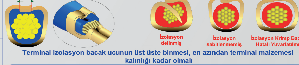
Sarma Conta Olmadan Contalı Krimp Bacakları Çok Uzun Aşırı Basılmış Yuvarlatılmamış Conta Sıkıştırmış Deforme Olmuş Krimpleme bacaklarının üst üste binmesi en az malzeme kalınlığı kadar olmalı.
