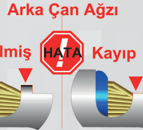
Görünür olmalı, maks. terminal kalınlığı kadar veya 0,5 mm Görünür olmalı / maks. 0,3 mm Conta hasar görmemeli veya deforme olmamalıdır!
