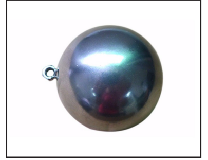
1 No.lu Deney Sondası (TS EN 61032 Şekil 5)
