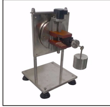
Yanlamasına Zorlamalara Dayanıklılık Test Cihazı
