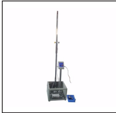
Bilye Düşürme Test Cihazı
