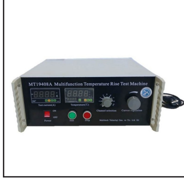
Sıcaklık Artışı Test Cihazı
