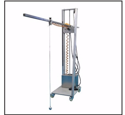
Sarkaç Bilye Düşürme Test Cihazı
